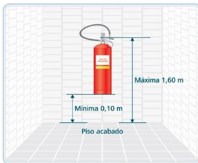
Figura 25 - Fixação extintor de incêndio
